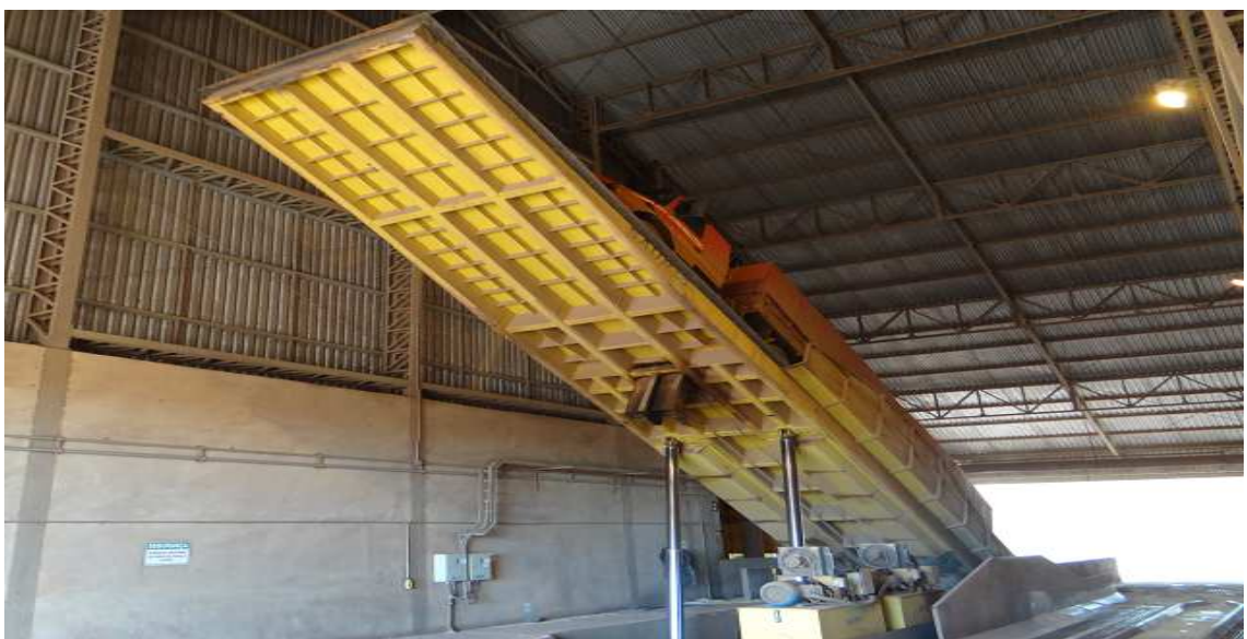
Figura 4 – Descarga de caminhão no tombador. Fonte: Arquivo pessoal.
