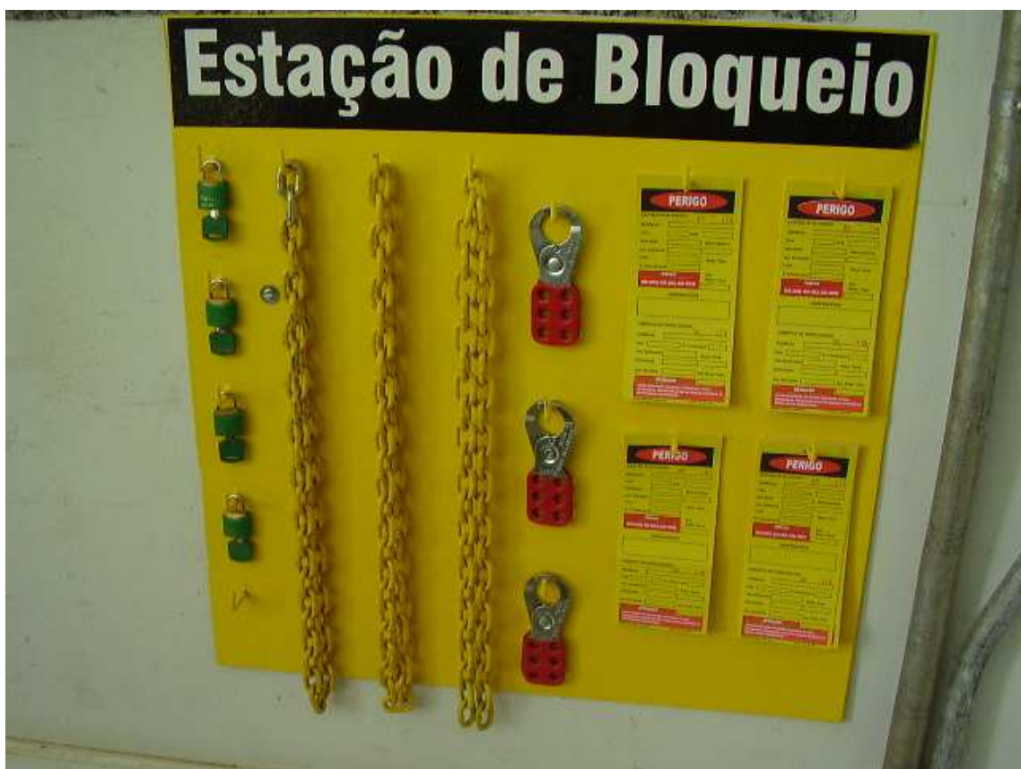
Figura 13 –Estação de bloqueio. Fonte – arquivo pessoal.
