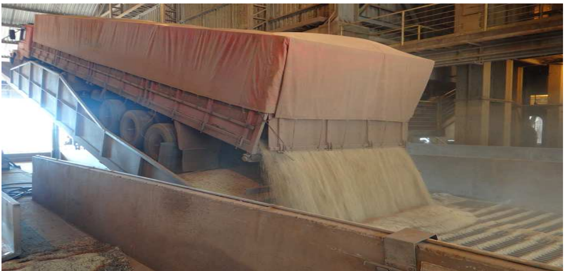
Figura 3 – Descarga de caminhão no tombador. Fonte: Arquivo pessoal.
